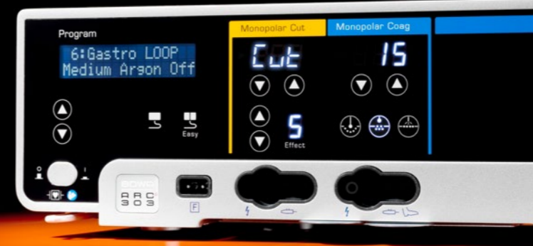
Функция GastroCut обеспечивает защиту от перфорации при полипэктомии, папиллотомии или эндоскопической резекции с помощью петель или электродов-игл
